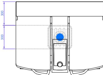
Die Wandrinne muss mit einem Gefälle von 1% in Richtung des fest Wand- oder Bodenabflusses montiert werden !!
